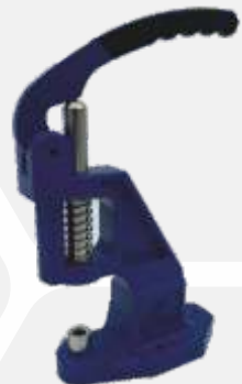
Manuel Kuş Gözü Makinesi Manuel Eyelet Machine
